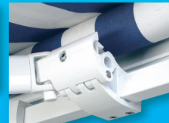
Kippgelenkarmlager mit selbstverriegelnder Hochschlagsicherung. Kippteile gesenkgeschmiedet
