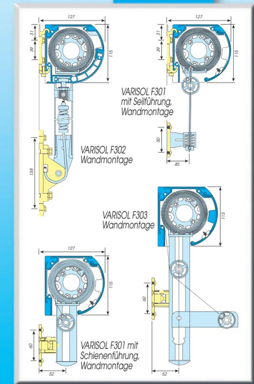
Fallarmmarkisen **VARISOL F302** mit Kastenprofil und einer besonders stabilen Fallstange. Diese ermöglicht eine maximale Breite der Markise von 5 m. Eine Kupplung von bis zu 3 Markisen (nur mit Motorantrieb) ist wie bei der VARISOL F301 möglich.
