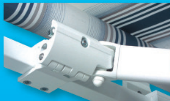
Kippgelenkarmlager mit selbstverriegelnder Hochschlagsicherung. Kippteile gesenkgeschmiedet
